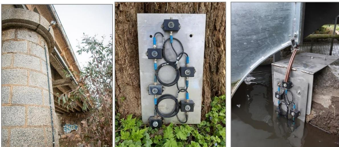
*Figure 2 : Exemple d'installation d'une gaine sur une pile de pont et support rigide utilisé pour fixer le capteur*
